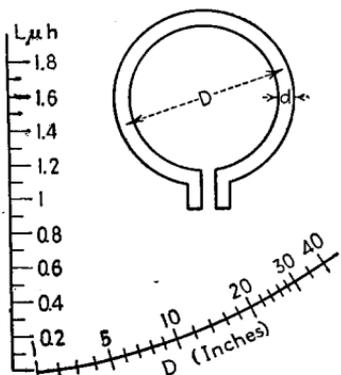
$$L_0 = 0.01016l \left( 2.303 \log_{10} \frac{D}{b+c} + 1.5 - \frac{D}{l} + 0.2235 \frac{b+c}{l} \right) \text{ microhenrys} \quad (28)$$
