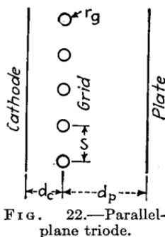
FIG. 22.—Parallel-plane triode.
