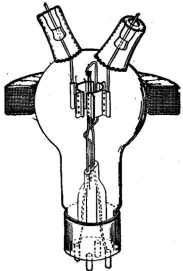
Fig. 35.—The split-anode magnetron.
